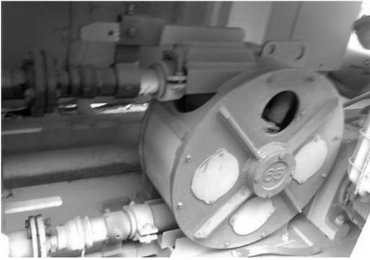
图 1 挤压胶管泵实物图
