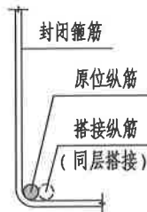
图11 封闭箍筋转角位置 (转角处无弯钩)
