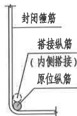
图11 封闭箍筋转角位置 (转角处无弯钩)
