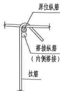
图12 拉筋弯钩位置
