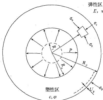
图 1 圆柱形孔扩张问题
