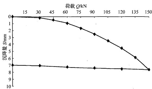
图 2 静载荷试验 Q-S 曲线图
